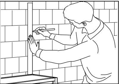
Après avoir installé le meuble pour lavabo, tirez un trait vertical à partir du côté du meuble pour lavabo.
